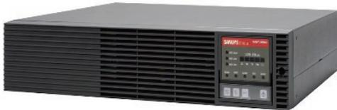
UPS:Uninterruptible Power Supplyは、商用電源などの電源トラブル時にも電気を停めることなく給電し続ける電源装置です。回路は、交流電源を直流に変える整流器や直流電力を交流に変えるインバータおよび、蓄電池などで構成されており、停電時には蓄電池に蓄えられた直流電力をインバータで交流電力に変換して供給します。
